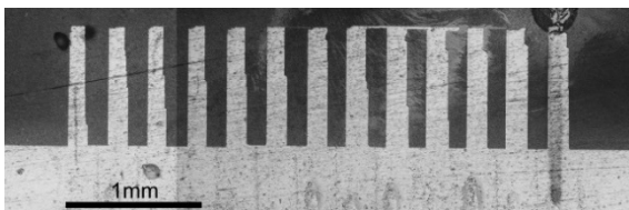
Figure 2. 四ホウ酸リチウムの周期双晶.
